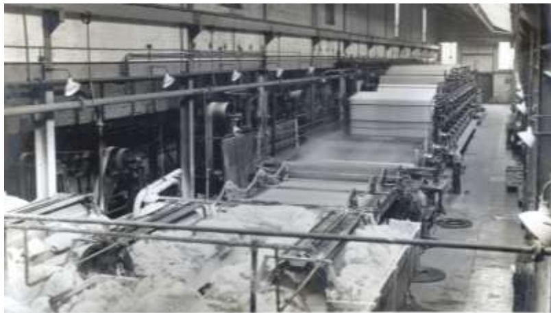
Figura 2.1 - “The Fourdrinier Machine” Fonte: http://www.sapphire.ac.uk/machine.jpg
