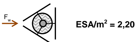
Figura 4.30 - Valor da área equivalente ESA por m^2 , para a interface triangular.
