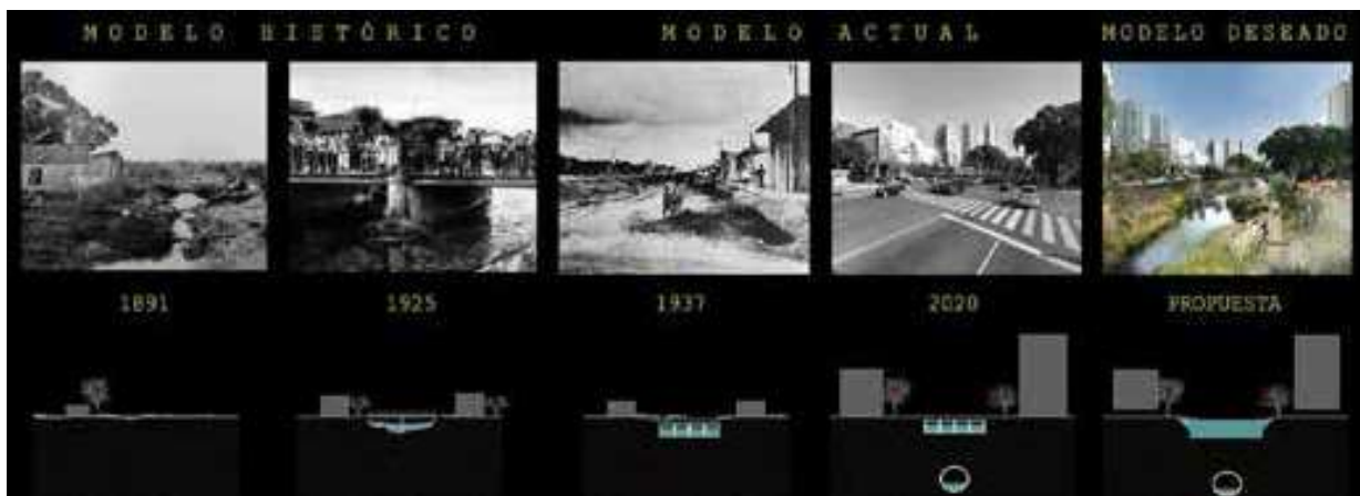
Figura 2: Fotomontaje con propuesta de incremento de capacidad de absorción y retención de agua mediante SUDS y ampliación de espacio público para modos no motorizados (izq.) y superficie absorbente y reservorios propuestos para la Cuenca del Arroyo Medrano (CAM) (der.). Fuente: Elaboración propia.
