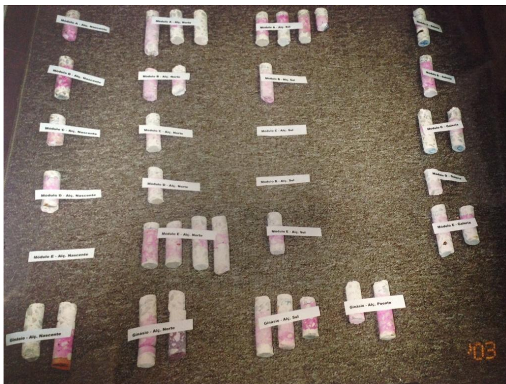
Figura 55 – Carotes extraídas dos alçados dos vários módulos com recurso à fenolftaleína, 2004
