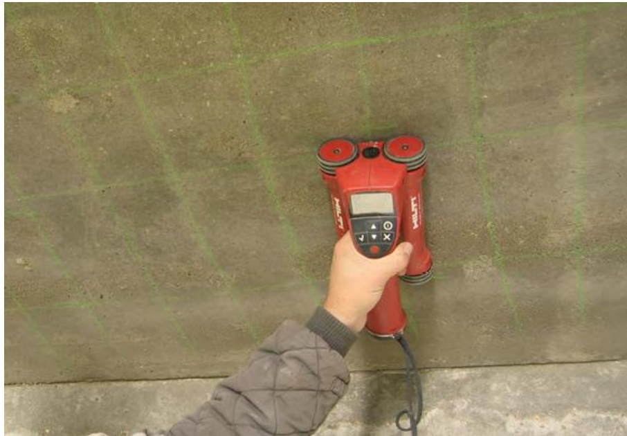
Figura 28 – Medição do recobrimento recorrendo ao pacómetro (LNEG, 2012)
