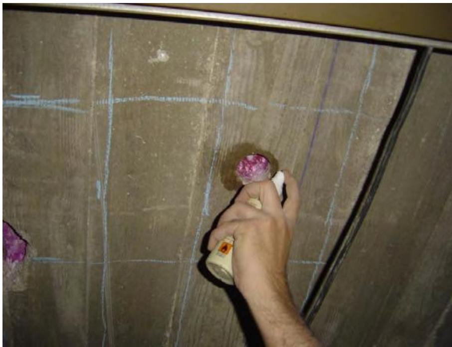
Figura 29 – Frente de carbonatação recorrendo à fenolftaleína (LNEG, 2012)
