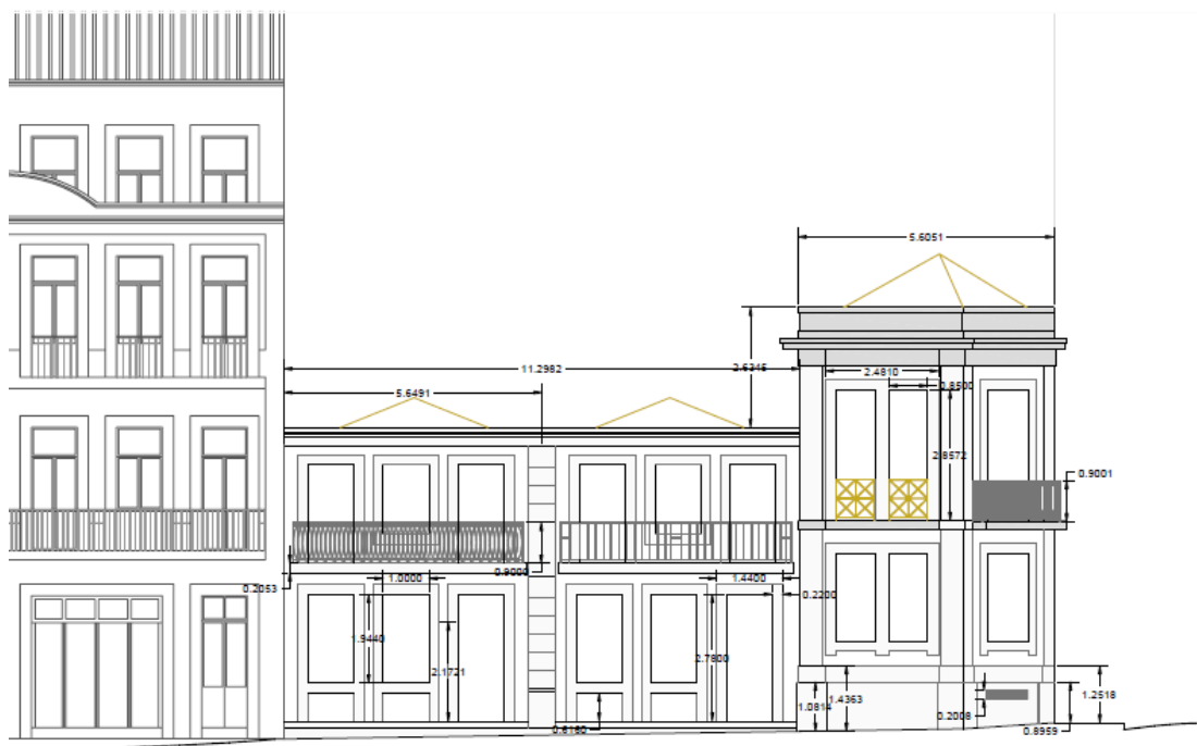
Figura 42 - Levantamento do Alçado da Rua do Sol
