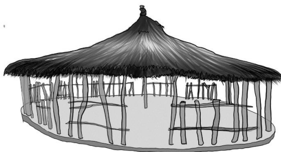
Figura 50-Desenho de um ondjango sem paredes com uma estrutura de troncos na Ilha Cazanga. Fonte: Desenho da autora a partir da revista ADPP Angola
