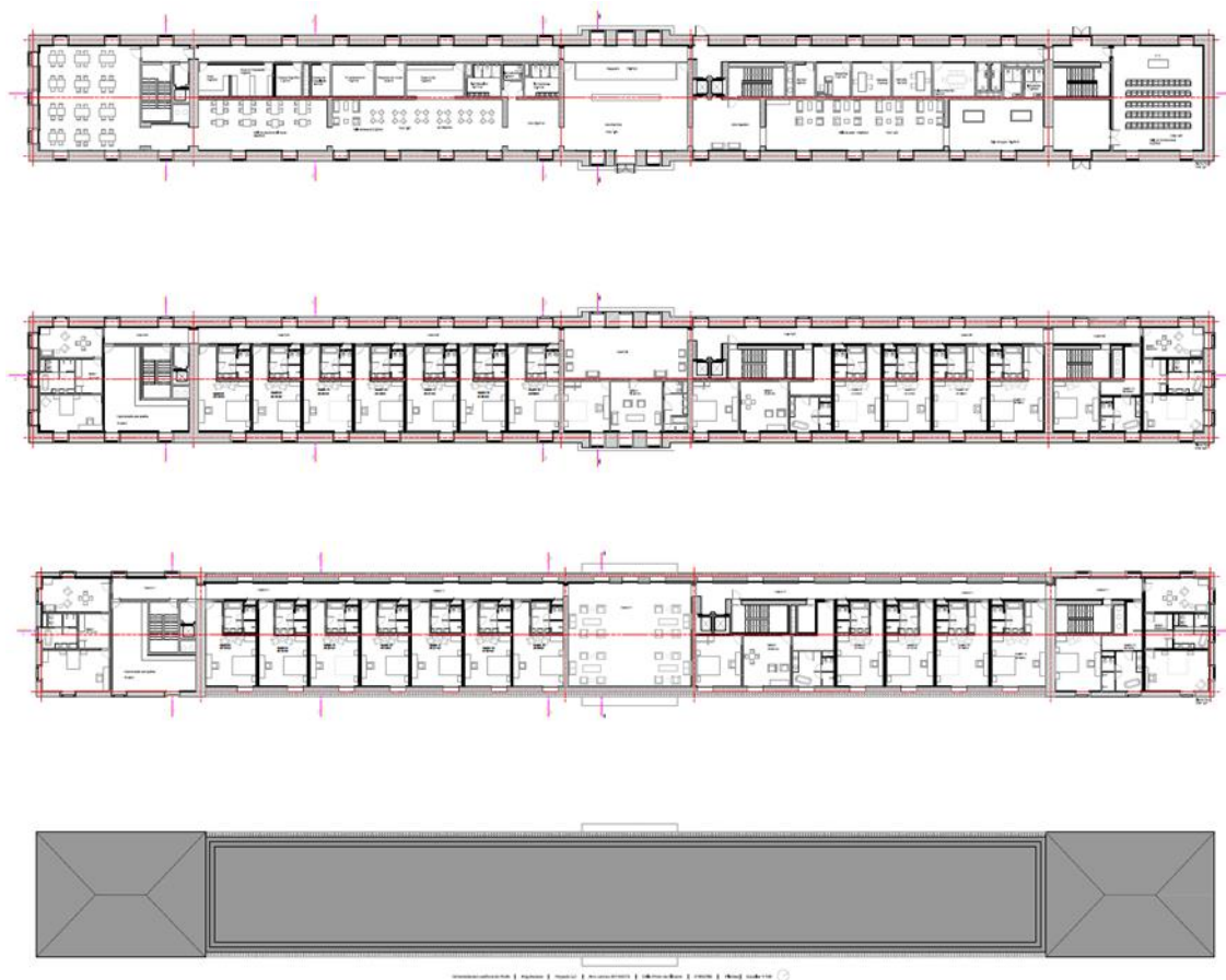
Figura 23 Plantas do piso 0, 1, 2 e cobertura (sem escala)
