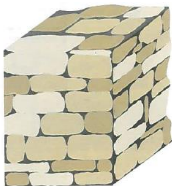
Figura 14 Montagem de blocos, com junta Desfasada.
