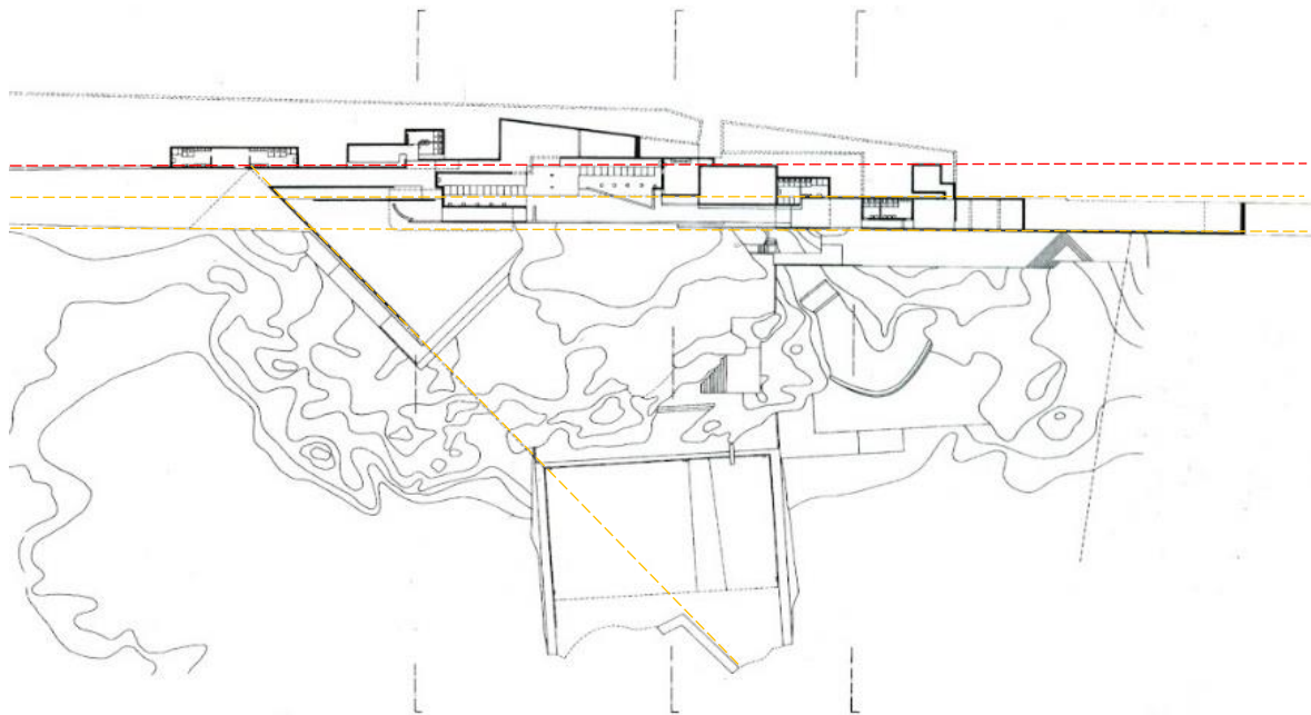
Figura [53]. Piscina das Marés, planta a cota dos balneareos, representação grafica dos alinhamentos seguis pelo arquiteto, (Vermelho – Alinhamento preexistente); (Amarelo – Planos alinhados pelo Preexistente); Siza Vieira, Leça da Palmeira, Matosinhos. (desenho sem escala) Disponível em: http://cargocollective.com/evtyson/4838799 - Consultado a: 21.10.2016
