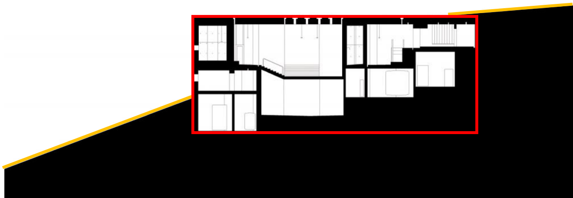
Figura [42]. Termas de Vals. Corte Tipo Transversal, Integração do Volume na topografia da montanha, ( Vermelho – Perímetro do Volume); ( Amarelo – Forma do Terreno); Peter Zumthor, Vals, Suíça, (desenho sem escala) Disponível em: http://www.archdaily.com/13358/the-therme-vals – Consultado a: 20/10/2016 às 16:23
