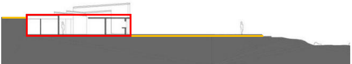
Figura [40]. Piscinas das Marés, Corte Tipo Transversal, o volume projetado relaciona a cota da marginal com a cota da praia (Vermelho – Perímetro do Volume); (Amarelo – Forma do Terreno); Álvaro Siza Vieira, Leça da Palmeira, Portugal. (desenho sem escala) Disponível em: http://3.bp.blogspot.com/-8nNY_wuRGik/T_Kw9XfKRiI/AAAAAAAAAZU/hpMGXYgPz68/s1600/la+minas+5+6.jpg - Consultado a: 21/10/2016 às 23:41
