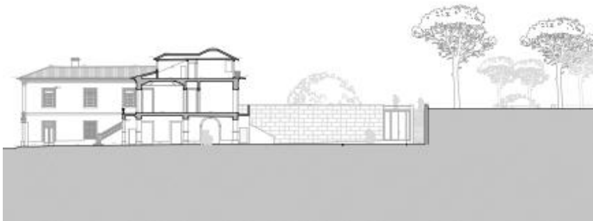
Figura [68]. Alçado Poente da Escola de Dança, relação entre a proposta, a escola de música, e o pátio que possibilita a mesma. Uso do material presente na envolvente na imagem do volume. (desenho sem escala) Figura desenvolvida pelo autor
