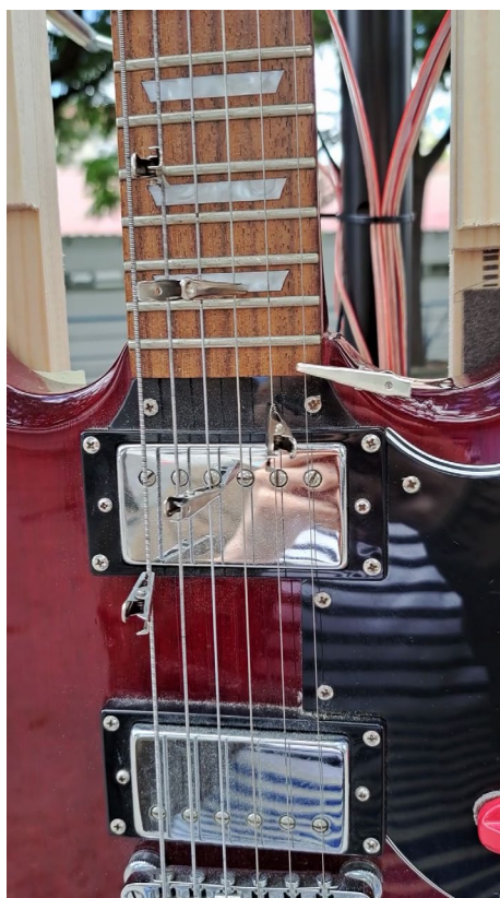
Figura 43 — Garras de crocodilo presas às cordas da guitarra de sonificação das PM.
