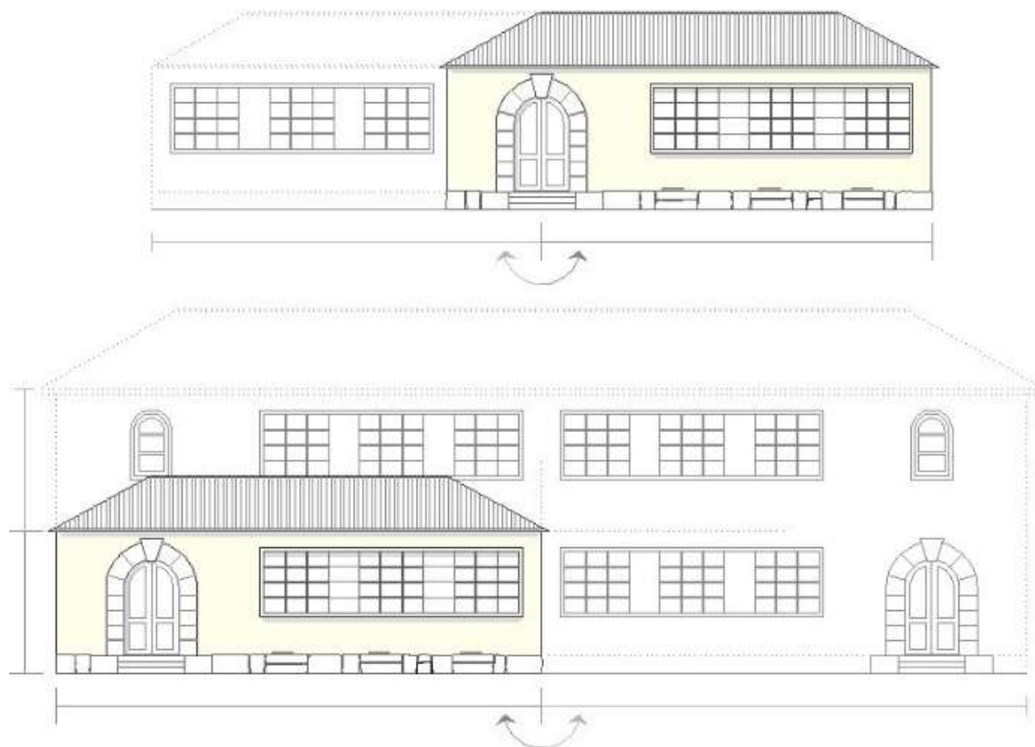
Figura 25 - Geminação e Multiplicação do projeto-tipo na construção de uma Escola dos Centenários.
