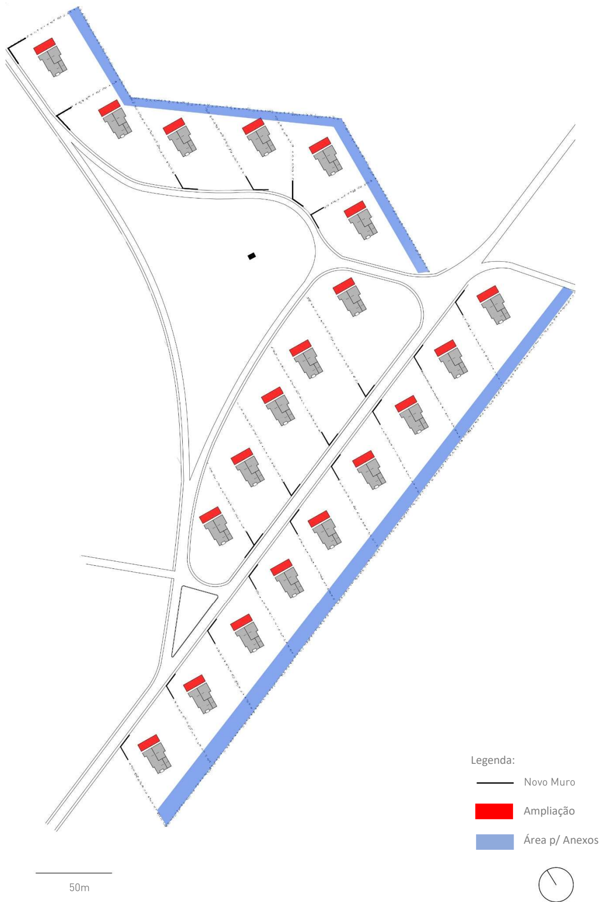
Figura 187 - Hipótese propositiva com construção muro tipo e ampliação do módulo em Casais da Veiga.
