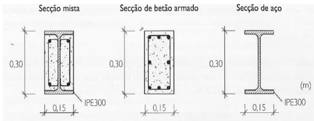
Figura 2.21 – Soluções estruturais para colunas (Calado & Santos, 2013)
