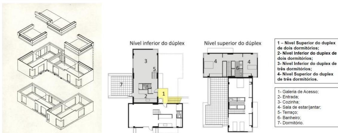
Figura 2 - Montagem Modulo Base e Planta Tipo.
