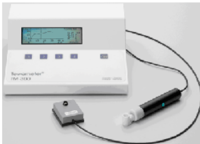
Figura 2: Tewameter TM300 (Courage-Khazaka, GmbH, Colónia, Alemanha)
