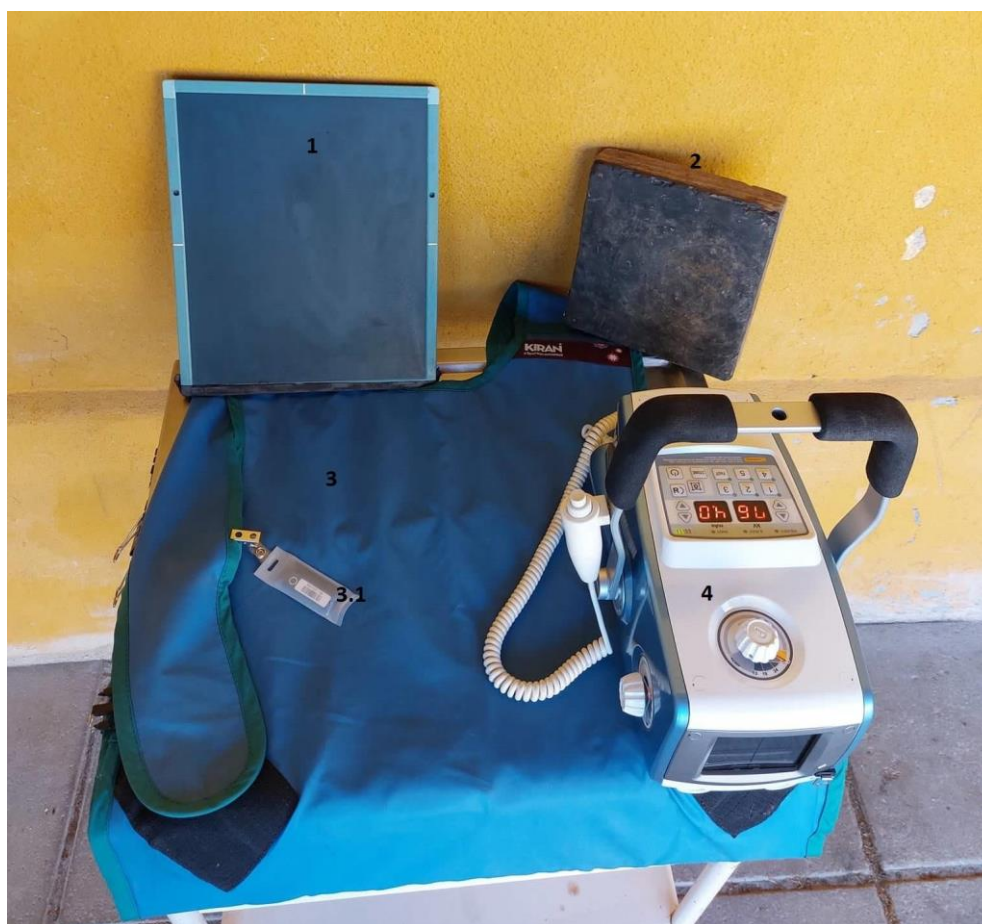
Figura 18: Material utilizado para as radiografias 1) placa de raio x; 2) bloco de madeira; 3) colete de chumbo; 3.1) dosímetro; 4) ampola de raio x.
