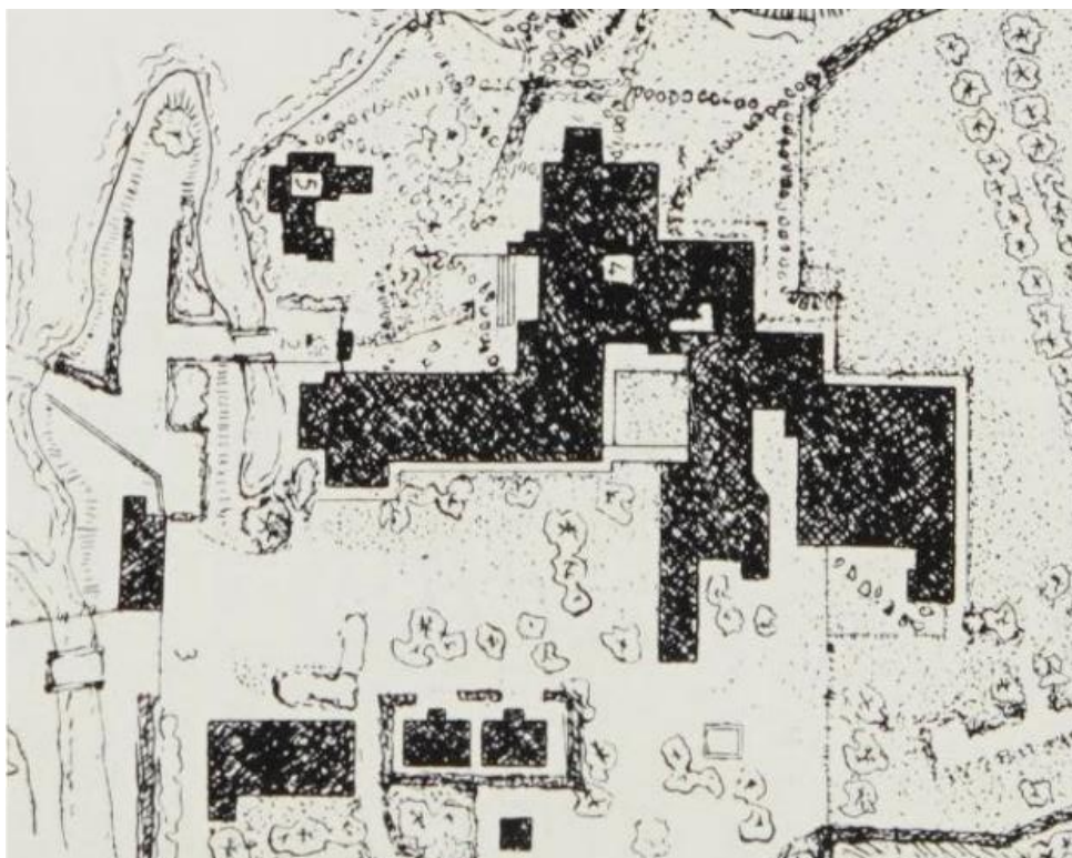
Figura 94 O princípio aditivo de espaço na Vila Imperial de Katsura cria uma elevação escalonada, aumentando a interação entre o interior e o jardim, por Tetsuro Yoshida em The Japanese House and Gardens , p.32.
