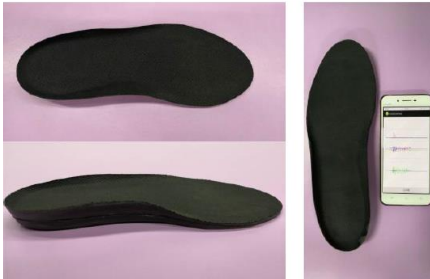
Figura 8 - A palmilha inteligente é ligada ao telemóvel para o registo de dados. Fonte: (L. Wang et al., 2019)
