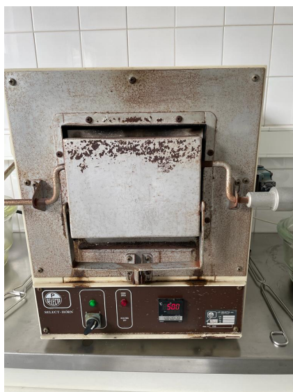
Figura 27 – Esquerda - Mufla utilizada para queimar matéria orgânica; direita - Exsicador utilizado para que as amostras atinjam a temperatura ambiente sem ganharem humidade (fotos de: Luivana Sousa, 17/02/2022).
