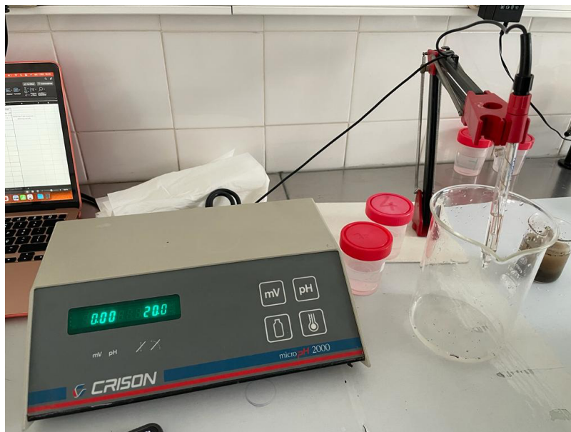
Figura 29 - Aparelho utilizado para medir o pH da solução aquosa em contacto com o sedimento (foto de: Luivana Sousa, 17/02/2022).
