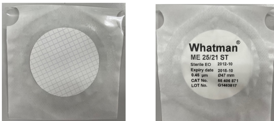
Figura 20 - (a - esquerda) Membrana de Filtração 0,45µm – parte da frente, (b - direita) Membrana de Filtração 0,45µm – parte de trás (foto de: Luivana Sousa, 09/02/2022).
