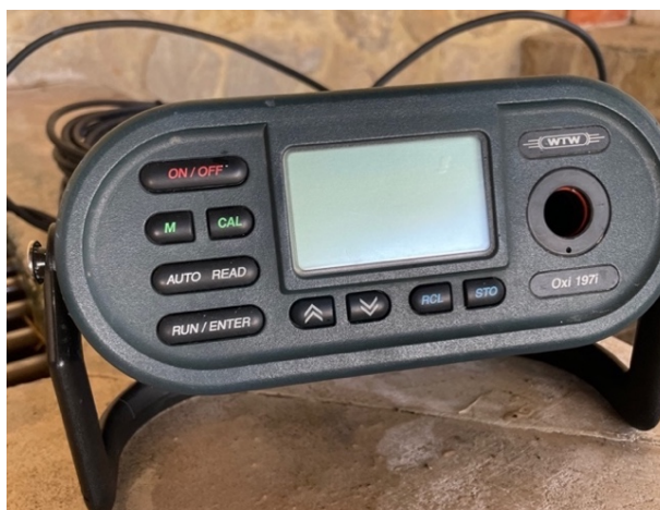
Figura 13 - Oxímetro utilizado para medir o Oxigénio Dissolvido e percentagem de Saturação de Oxigénio Dissolvido (foto de: Luivana Sousa, 08/02/2022).
