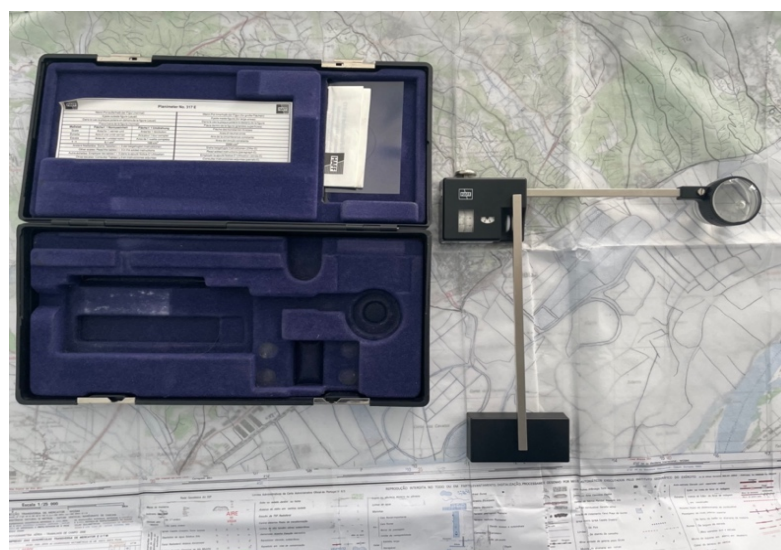
Figura 11 – Planímetro utilizado para a determinação manual das áreas das bacias hidrográficas consideradas na região do município de Azambuja (foto de Luivana Sousa, 17/03/2022).
