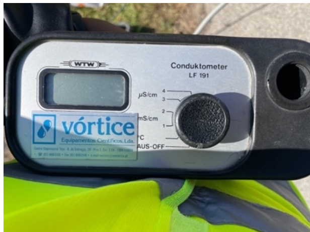
Figura 12 - Condutivímetro utilizado para medir a Temperatura, Condutividade e Salinidade (foto de: Luivana Sousa, 08/02/2022).
