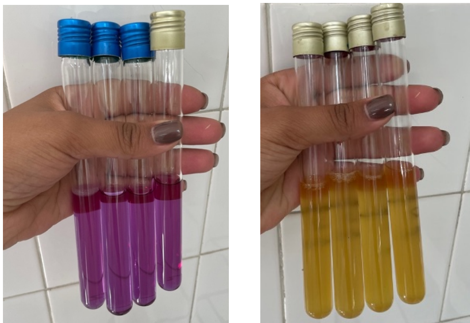
Figura 22 - (esquerda – meio Lactose Peptone Broth DEV (Fluorocult) preparado para repicagem; direita – após a incubação, viragem da cor do meio para amarelo, confirmando a presença de Escherichia coli (foto de: Luivana Sousa, 11/02/2022).
