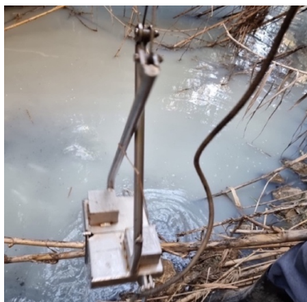
Figura 18 – Equipamento Dragas Van Veen na recolha da amostra G15 (foto de: Ana Rita Pereira, 07/02/2022).
