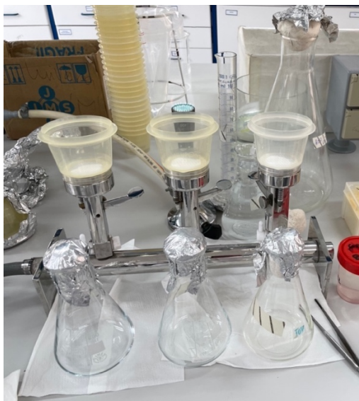
Figura 19 – Equipamento para filtração das amostras, Rampa de filtração, Merck Millipore (foto de: Luivana Sousa, 09/02/2022).
