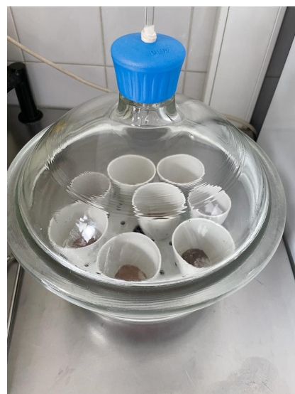
Figura 27 – Esquerda - Mufla utilizada para queimar matéria orgânica; direita - Exsicador utilizado para que as amostras atinjam a temperatura ambiente sem ganharem humidade (fotos de: Luivana Sousa, 17/02/2022).
