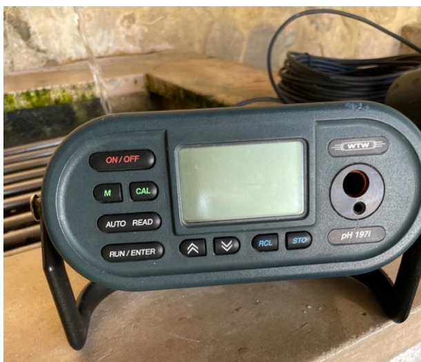
Figura 14 – Sonda potenciométrica utilizada para medir o pH (foto de: Luivana Sousa, 08/02/2022).
