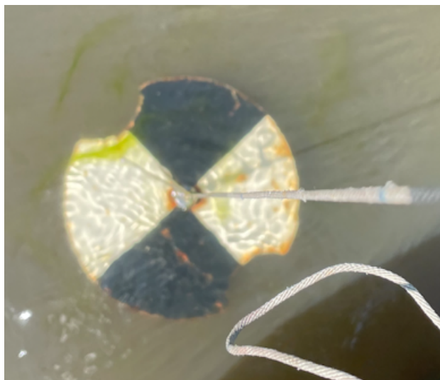
Figura 15 – Disco de Secchi utilizado para estimar a profundidade e transparência da água (foto de: Luivana Sousa, 08/02/2022).
