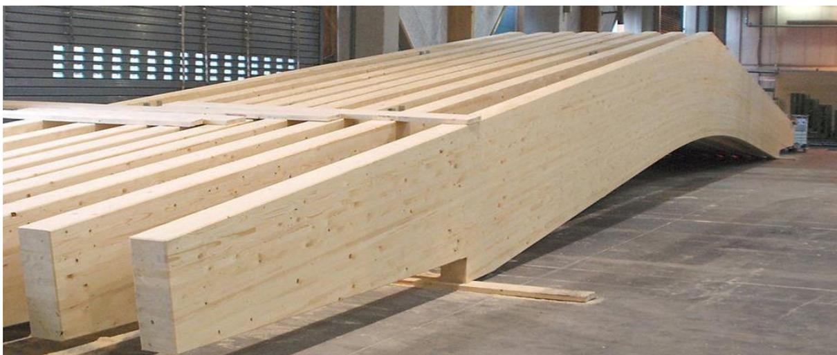
**Fig. 29** - Estrutura de madeira lamelada-colada cruzada, painéis de grande dimensão. **Fonte:**
