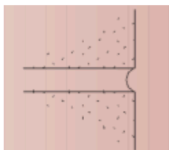
12. Junta Côncava (condições atmosféricas severas)
