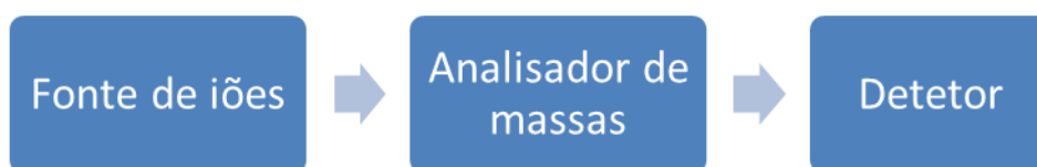
Fig. 4. Representação esquemática de um espectrómetro de massas
