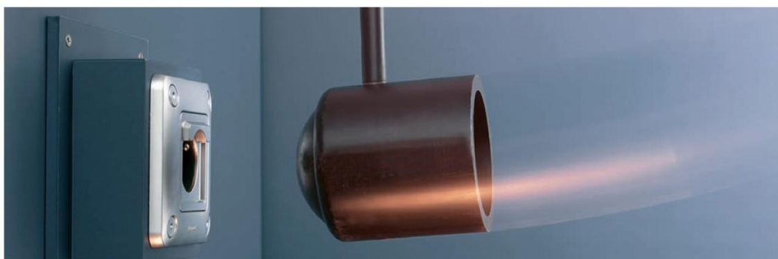
IK 10 : RESISTÊNCIA MÁXIMA AOS CHOQUES | Todos os produtos resistem a choques de 20 joules
