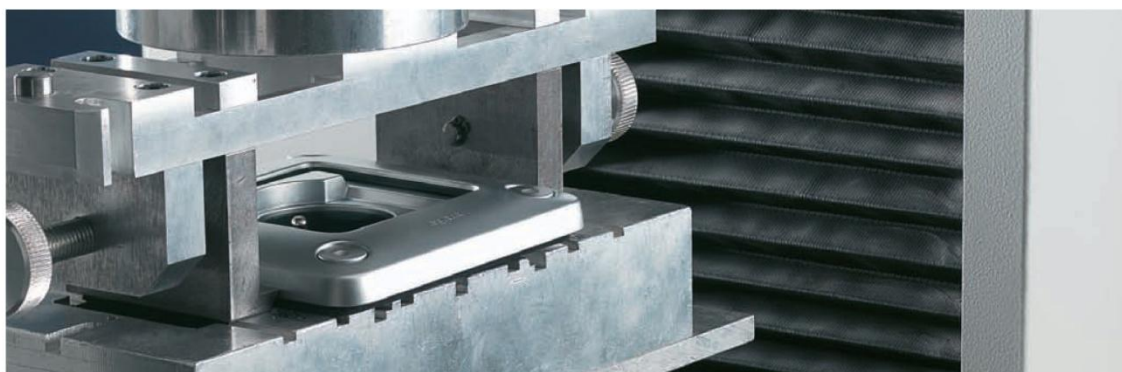
IK 10 : RESISTÊNCIA MÁXIMA AO ARRANQUE | Forma torneada dos quadros e tampões para obturar parafusos de fixação (evitar arrancamentos e manipulações)
