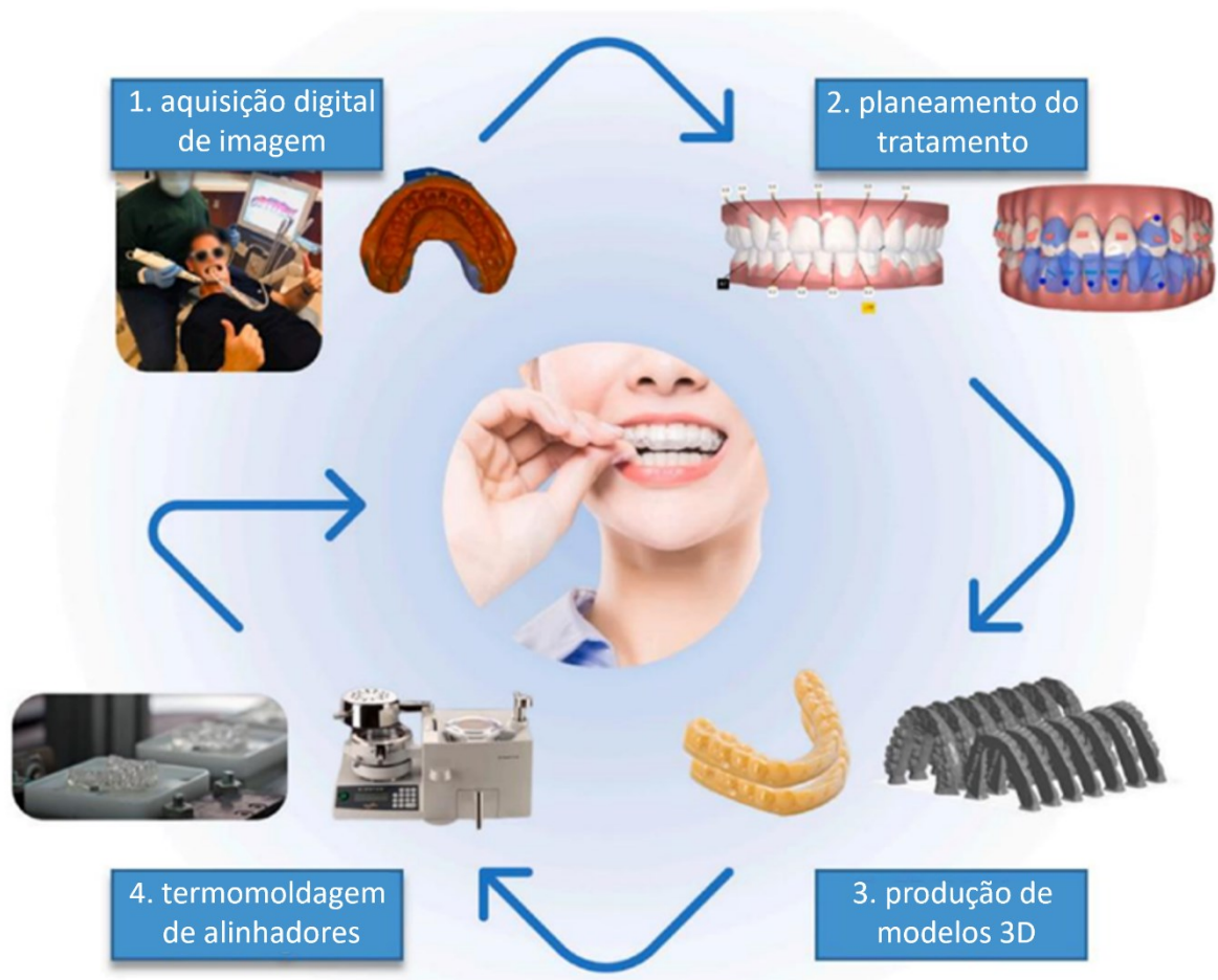
Figura 6- Fluxo de trabalho do fabrico de alinhadores transparentes pelo processo de termomoldagem - adaptado de Bichu et al., 2023
