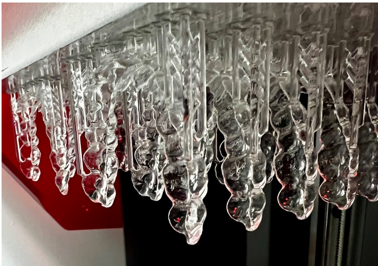
Figura 2 - Alinhadores impressos diretamente - adaptado de Tsolakis et al., 2022
