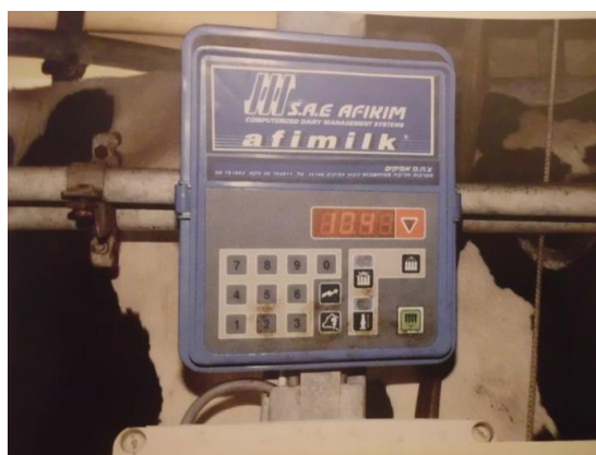
Figura 10 – Sistemas de deteção da condutividade elétrica e registo diário em cada ordenha, transmitindo a informação para o computador a fim de estabelecer registos diários da condutividade (Saran & Chaffer, 2000)
