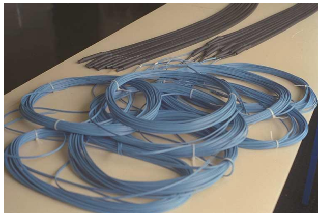
Figura 5 – Cabos de fibra ótica (Halvorsen & Motzko, 2000)
