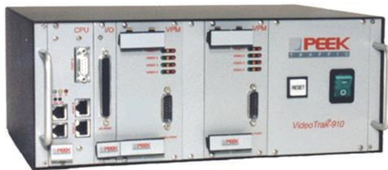
Figura 9 – Processador de imagens de vídeo “Closed-loop tracking” (Klein et al., 2006).
