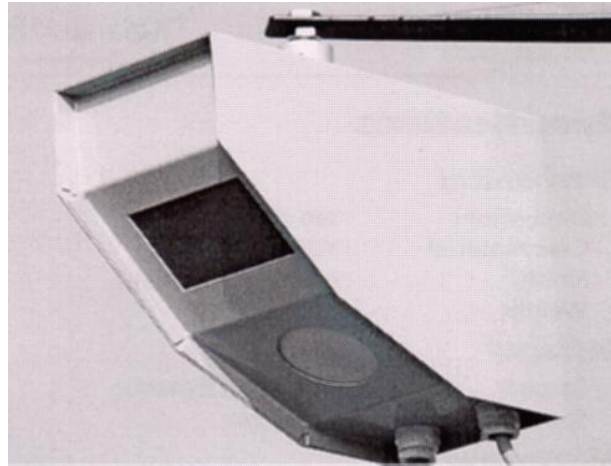
Figura 11 – Radar doppler de onda contínua ASIM DT 281 (Klein et al., 2006).
