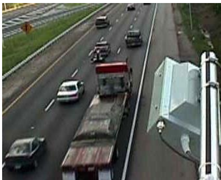
Figura 17 – Sensor acústico passivo SAS-1 (Klein et al., 2006).
