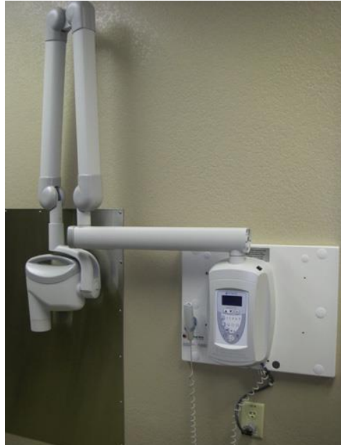
Figura 4: Exemplo de um gerador de raios X dentário, com um braço extensor e painel de controlo, fixo a uma parede (Coffman & Brigden, 2013).
