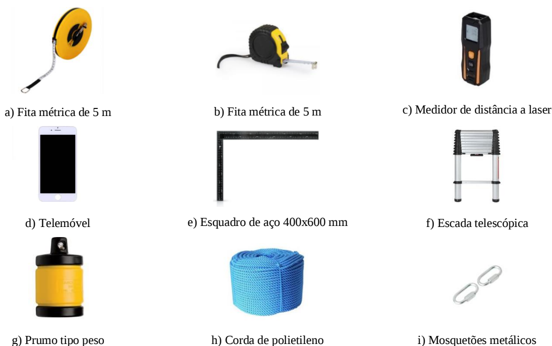
Figura 3.9 - Ferramentas e equipamentos utilizados nas inspeções de inventário
