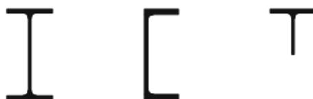
**Figura 37** - Perfis com flanges paralelos do tipo IPE, UAP e IPET
