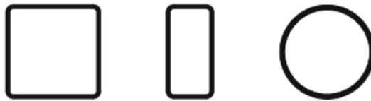
**Figura 38** – Perfis Estruturais Tubulares Ocos com formatos quadrangulares (RRW / RRK), retangulares (RRW / RRK) e circulares (ROR)
