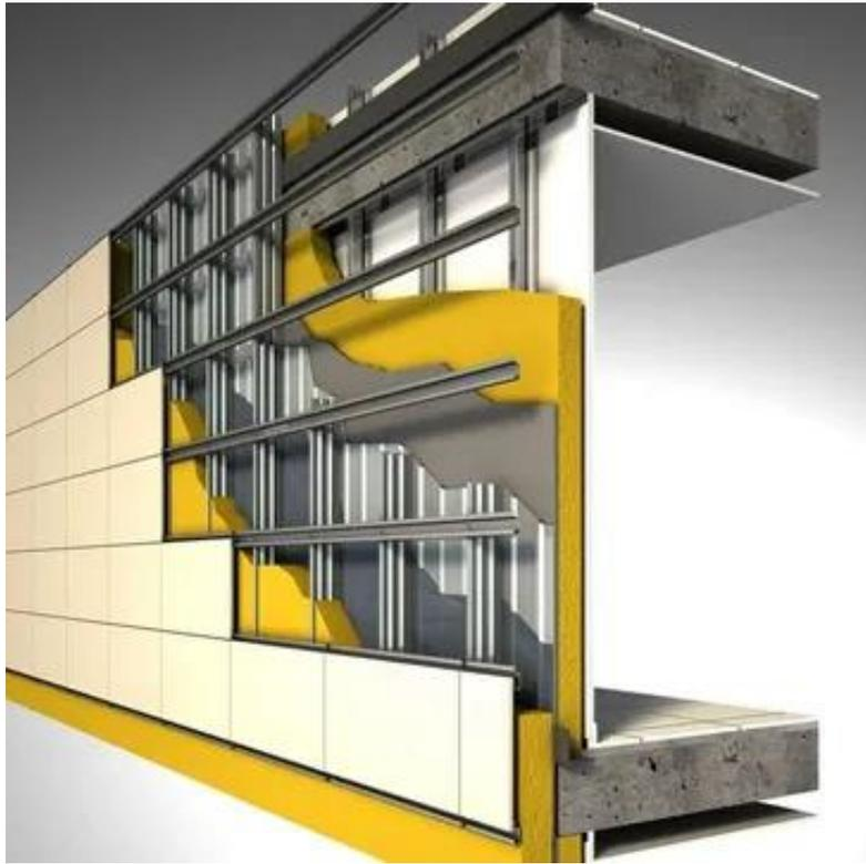
**Figura 29** - Constituição de uma fachada ventilada
