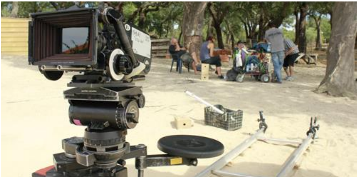
A Câmara Aaton de 16mm sobre a dolly Panther para utilização de travellings. Muito utilizado durante a rodagem do filme.
