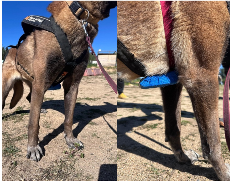
Figura 8: Posicionamento do Sensor Alogo Move Pro™ e fixação ao peitoral usando ataduras coesivas.
