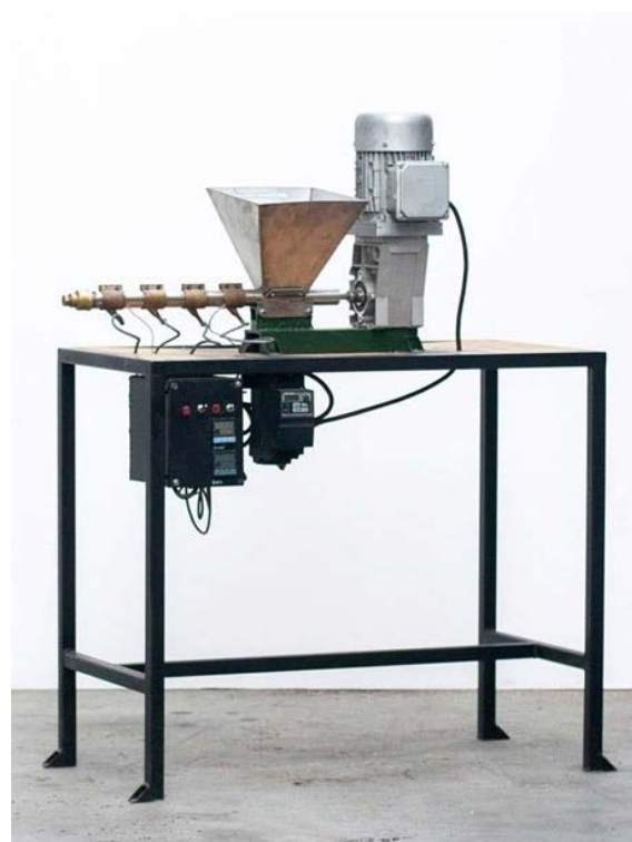
Figura 12 - Versão básica da extrusora da Precious Plastic
