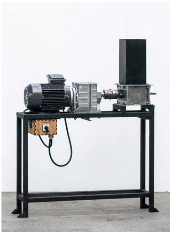
Figura 9 - Versão básica da trituradora «Precious Plastic»
