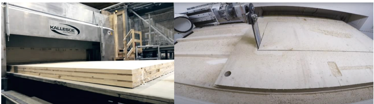
Figura 15 Prensagem e recorte das peças.
