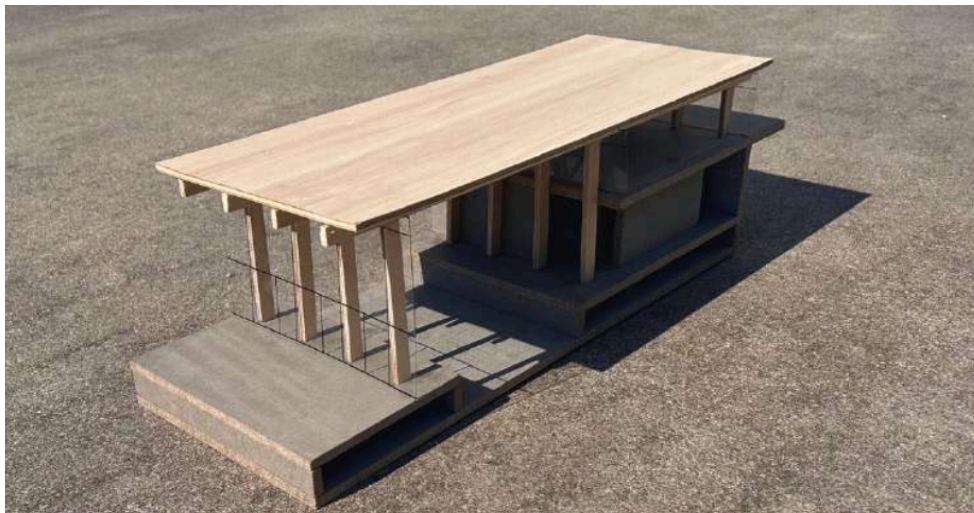
Figura 90 Maquete Corte Construtivo Complexo Desportivo.
