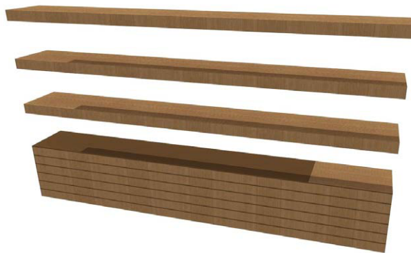
Figura 5 Esquema lamelas GLT.
