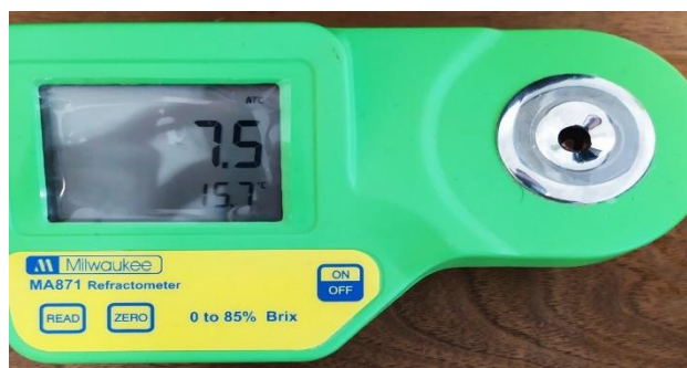
Figura 3: Refratômetro digital utilizado na medição do Brix sérico. Fonte: Original do autor
