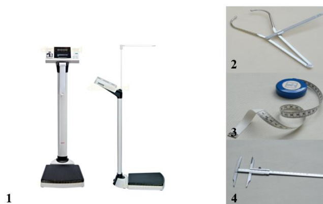
Figura 10. (1) – Balança digital e estadiômetro (SECA 764), (2) – Compasso de pontas curvas, (3) – fita métrica e (4) – compasso de corredeira.
