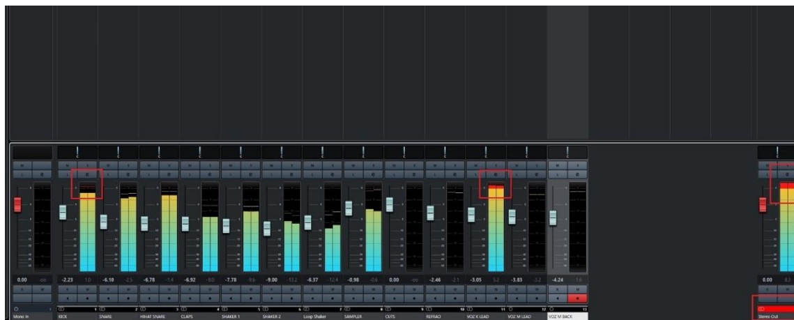
Figura 26 Gain Staging Incorreto
