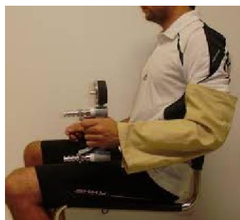
Figura 11. Teste de Força de Preensão Manual (Handgrip), Dinamómetro Takei TTK 4401, Japan.
