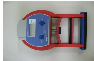
Figura 11. Teste de Força de Preensão Manual (Handgrip), Dinamómetro Takei TTK 4401, Japan.
