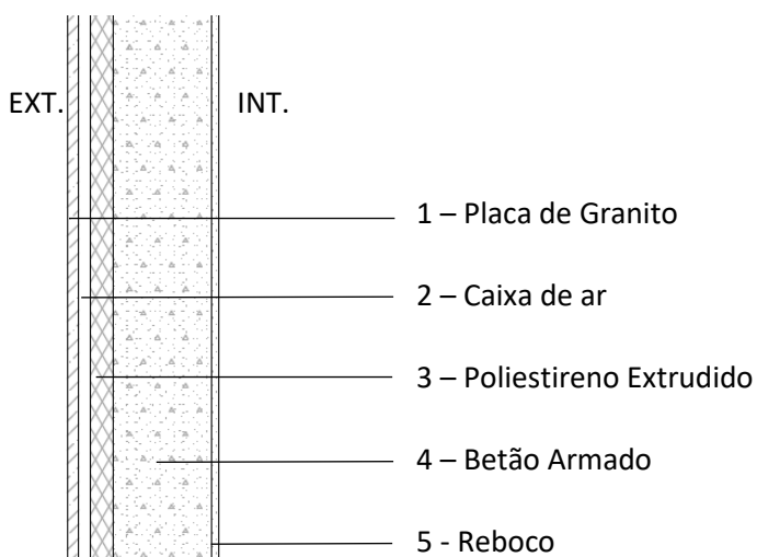
Fig. 108 - Corte construtivo de parede ventilada
