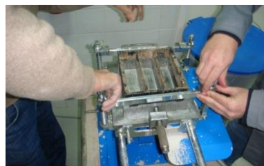
Figura 30 - Fixação do molde à compactadora
