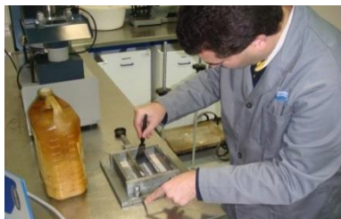
Figura 29 - Aplicação do descofrante
