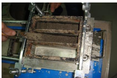
Figura 31 - Aplicação da argamassa no molde
