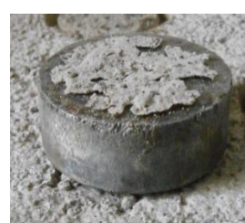
Figura 70 - Rotura de Topo
