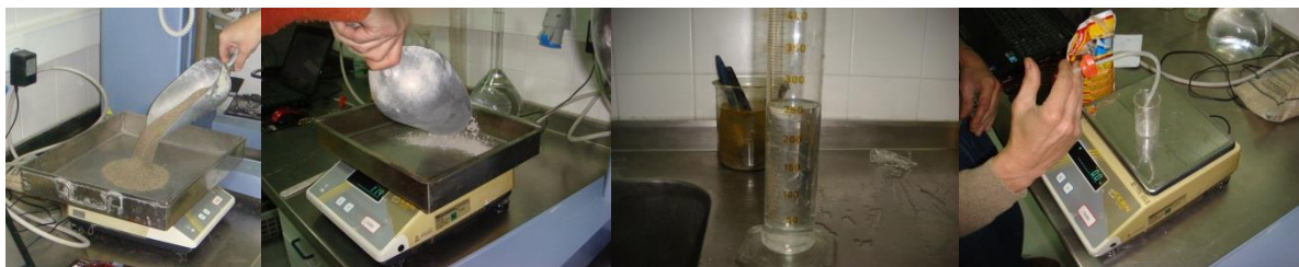
Figura 16 - Pesagem de cada constituinte das argamassas
