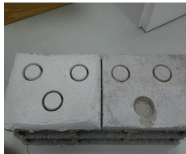
Figura 75 - Bloco pronto para iniciar o processo de colagem das pastilhas
