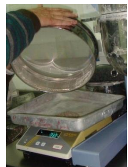
Figura 13 - Pesagem do material retido em cada peneiro
