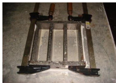
Figura 43 - Molde fixo e aplicação do descofrante
