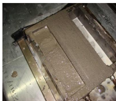
Figura 45 - Aplicação da 2ª mistura no molde
