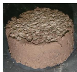
Figura 69 - Rotura pela cola
