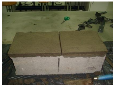
Figura 58 -Bloco com as duas misturas
