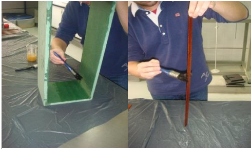
Figura 51 - Aplicação do descofrante
