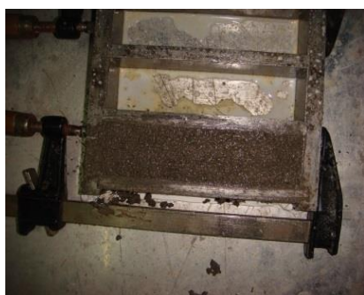
Figura 44 - Aplicação da 1ª mistura no molde
