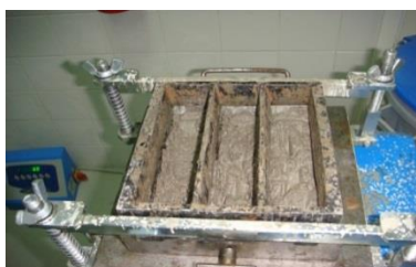
Figura 33 - Preenchimento total do molde
