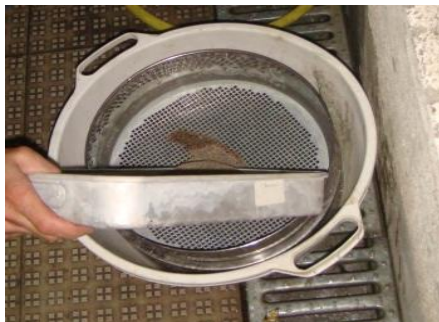
Figura 4 - Colocação do provete no recipiente
