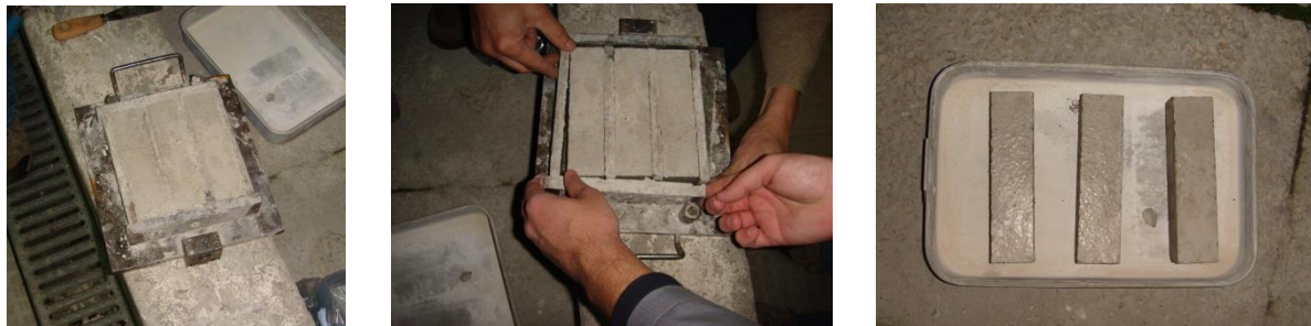
Figura 46 - Processo de desmoldagem
