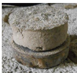
Figura 67 - Rotura tipo Argamassa
