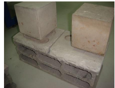
Figura 76 - Bloco em repouso após a colagem com carga aplicada na pastilha
