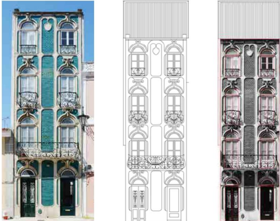
Figura 59. Fachada do edifício. Do largo nº19-20 (Leiria, 2011, APS)./ Processamento topográfico (2014, AMC,APS)/ Aplicação da função Rubbersheet do AutoCad Raster Design (2014, AMC, APS)
