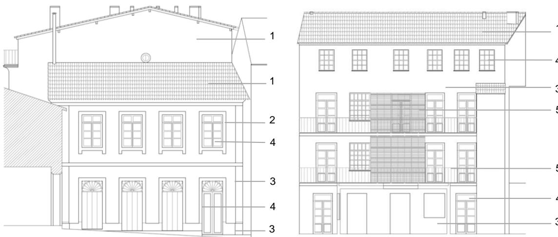
Legenda: 1 – Telha canudo, 2 – Reboco estanhado, 3 – Granito, 4 – Janelas e portas em madeira recuperadas e pintada, 5 – Ferro pintado
