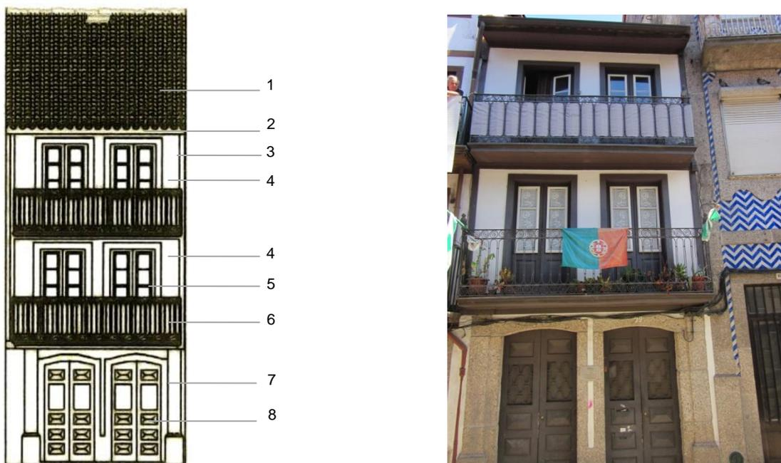
Legenda dos alçados: 1 – telha canudo, 2 – beiral em madeira, 3 – régua de madeira, 4 – parede em taipa de rodizio com reboco estanhado, 5 – reparação da caixilharia existente, 6 – gradeamento em ferro existente, 7 – alvenaria de granito, 8 – portas em madeira existentes e recuperadas.
