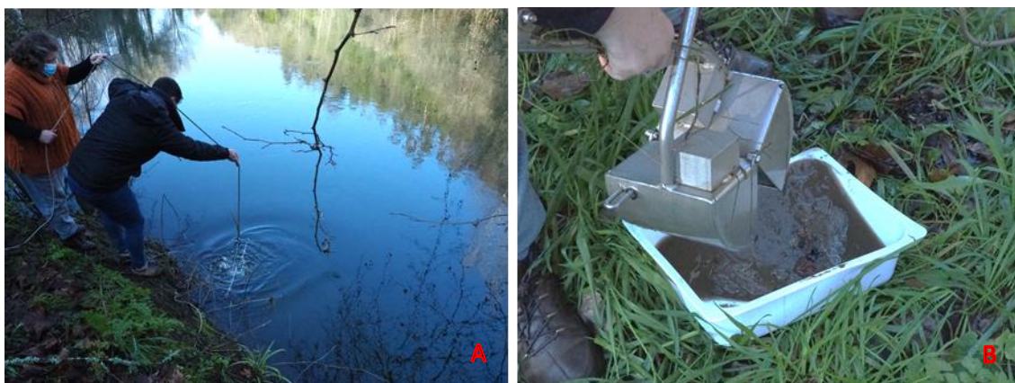
Figura 28 (A e B): Recolha de amostra de sedimentos com recurso a uma draga do tipo Van Veen (Fotos de: Ana Carolina Cruces Ferreira)
