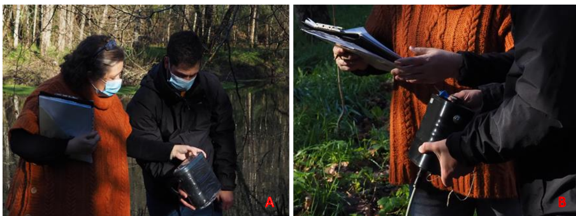
Figura 25 (A e B): Medição e leitura dos parâmetros com recurso a sonda multiparamétrica (Fotos de: Ana Carolina Cruces Ferreira).
