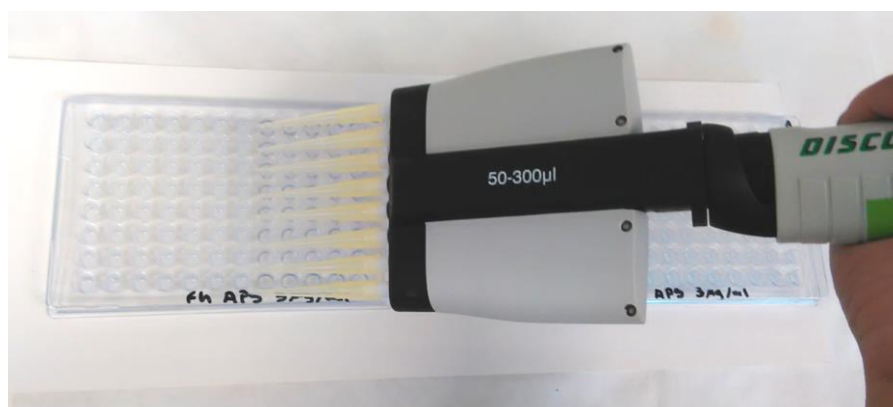
Figura 13 - Preenchimento dos poços da placa de ELISA com antígeno diluído em PBS (Fotografia original).
