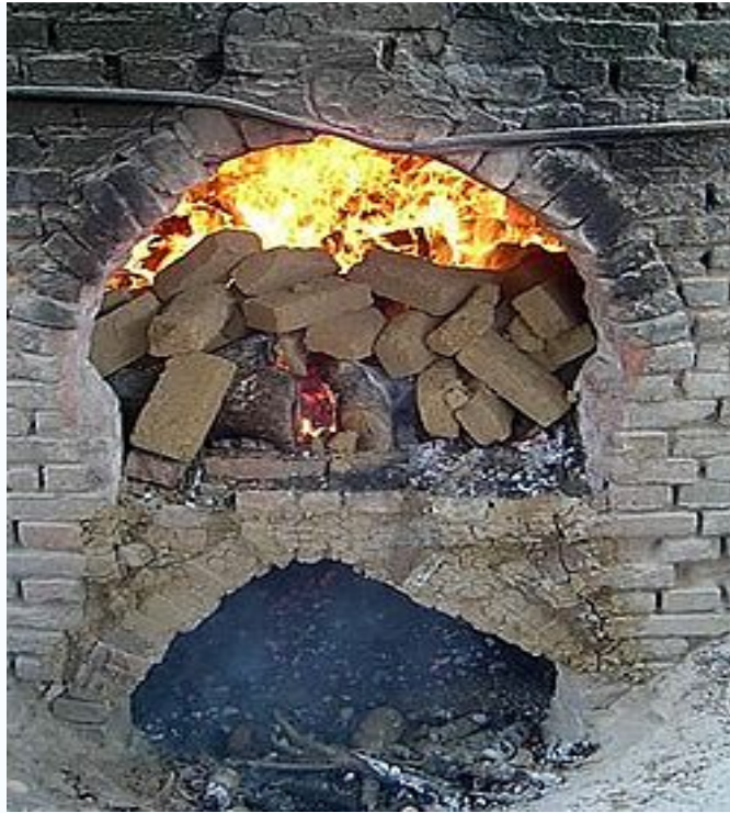
Fig.22 Forno para calcinação de tijolos de argila para produção de pozolanas. Foto ext.net.
