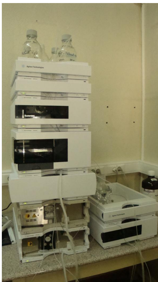
Figura 14. Aparelho de Cromatografia Líquida de Alta Performance utilizado na quantificação de micotoxinas (fonte: Original, 2011).
