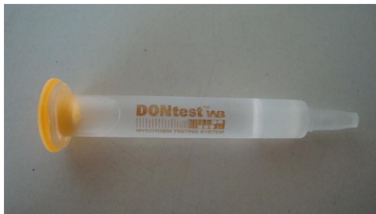
Figura 13. Coluna de imunoafinidade utilizada na extração de DON (fonte: Original, 2011).
