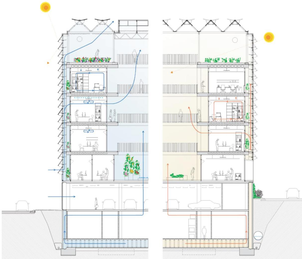
Figura 8 – Exemplo de circulação de ar proporcionado por uma correta escolha de materiais e de abertura de vãos. Centro de Investigación ICTA-ICP. UAB, Barcelona, Espanha - Harquitectes. Fonte: (Centro de Investigación ICTA-ICP. UAB, 2020, p. 99).
