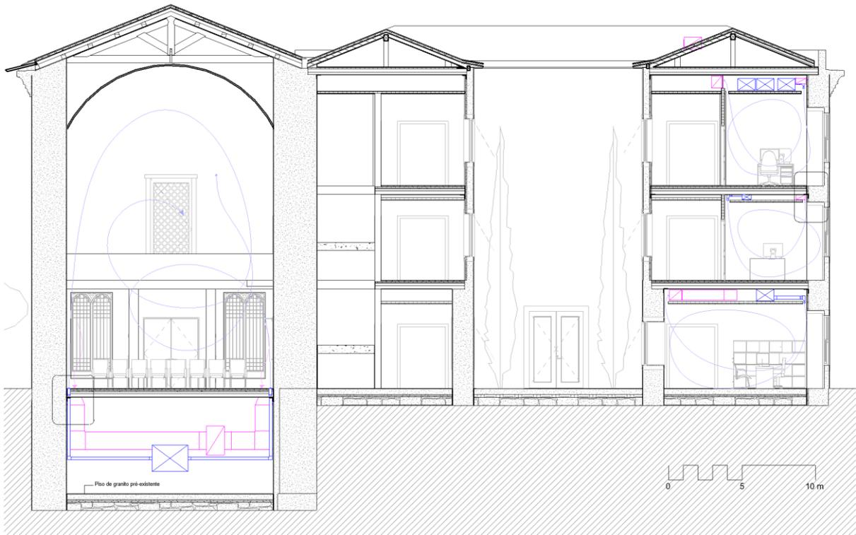
Figura 78 – Corte com esquema de insuflação e recolha de ar.
