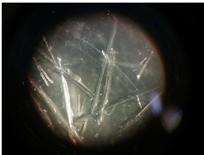
Figura 6. Cristais de halimano observados ao microscópio após segunda recristalização.
