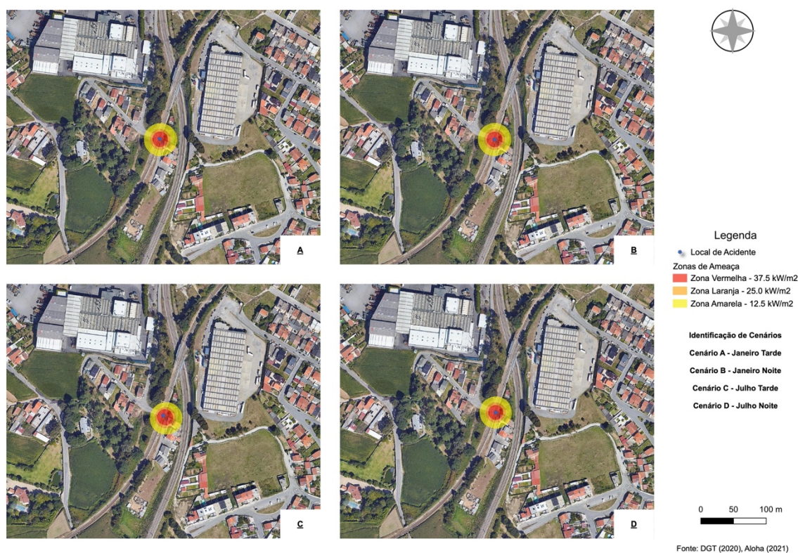
Figura 45. Zonas de ameaça para o edificado provocadas pelos efeitos térmicos do pool fire
