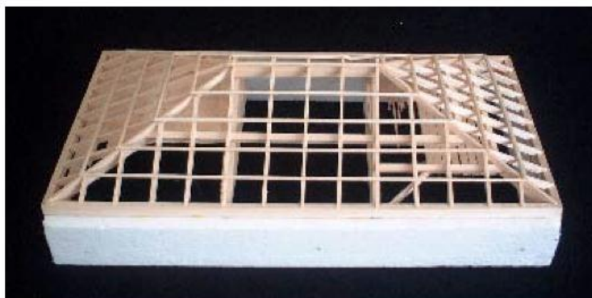
Figura 47 – Estrutura de cobertura com quatro águas constituída por elementos em forma de paus rolados e asnas simples com nível e com tetos em masseira. Maqueta realizada por um grupo de alunos do ano 1999/2000 FAUP. Fonte: (Teixeira, 2004).
