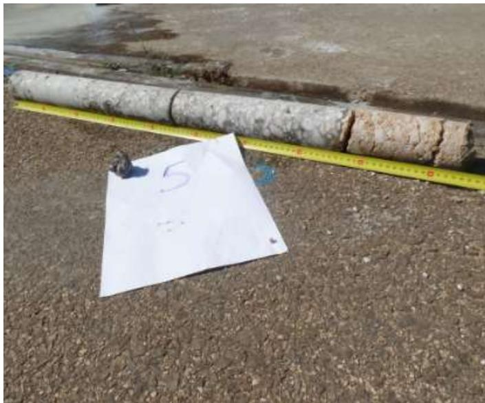
Figuras 25 e 26 – Ensaio de carotagem em pavimento de betão;
