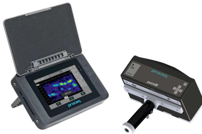
Figura 17 – Aparelho de tomografia sónica;
