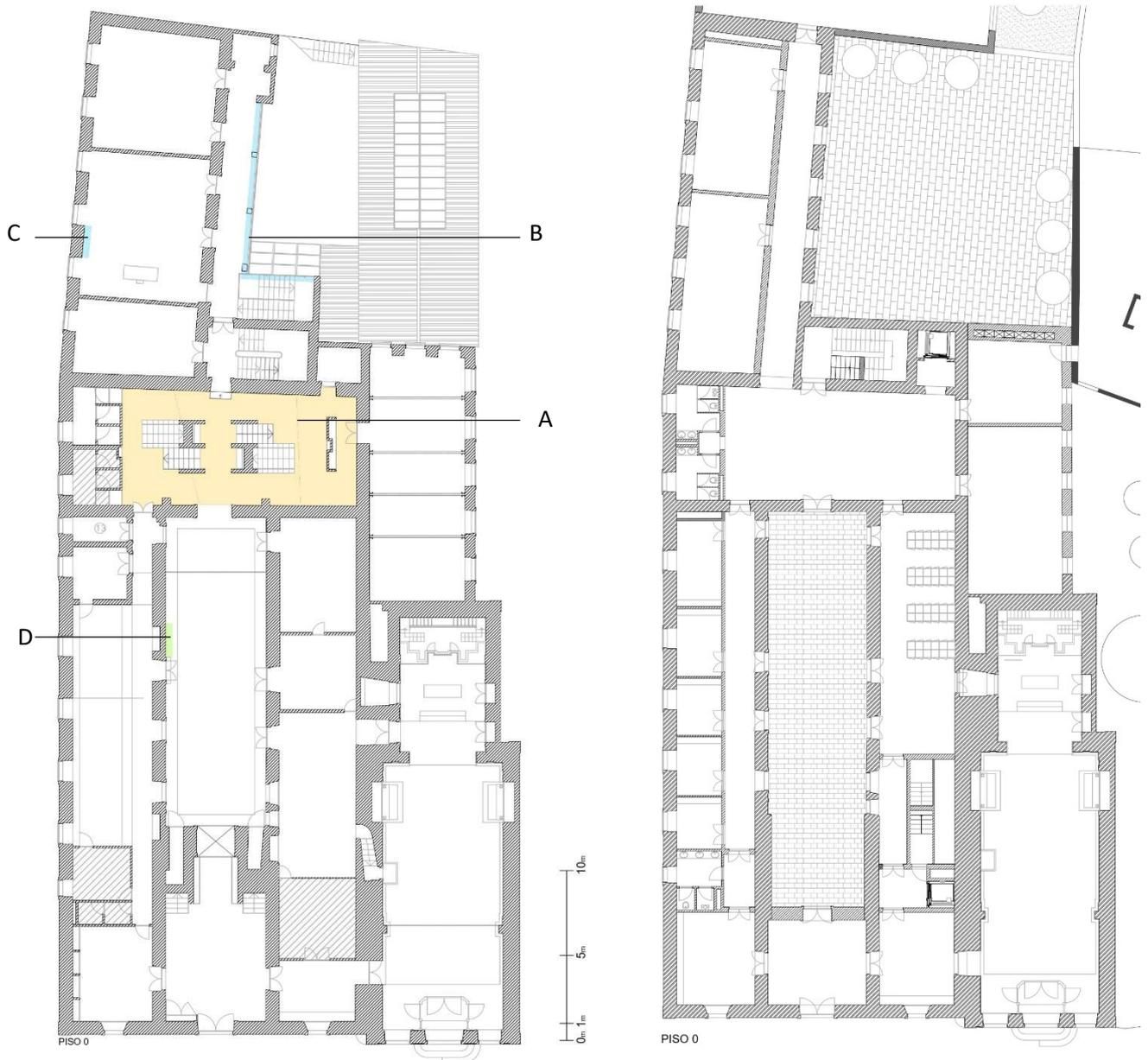
Figura 83 e 84 - Levantamento de patologias piso 0; Planta do piso 0 - Proposta;
