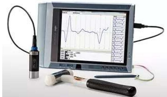
Figura 15 – Aparelho de ensaios sónicos;
