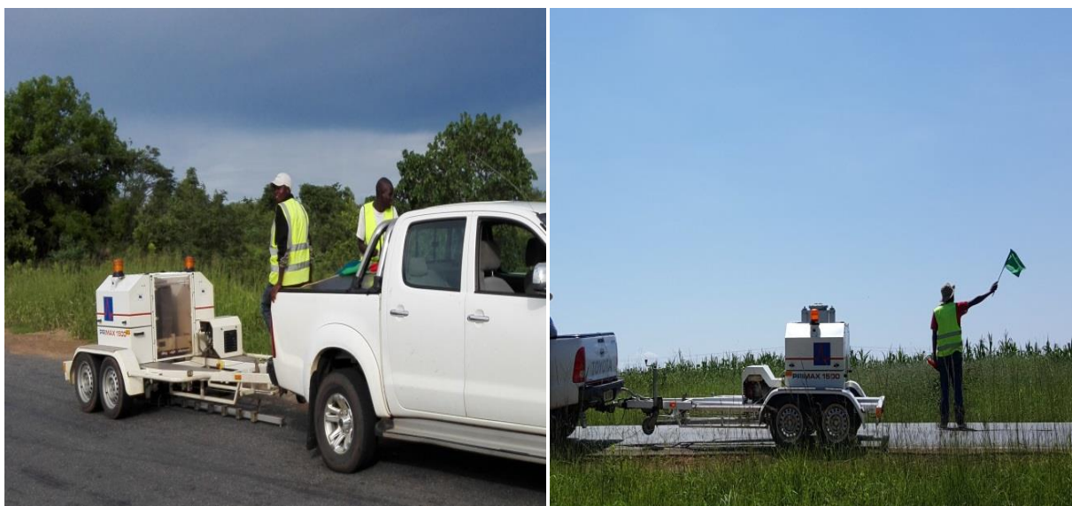
Figura 13 – Teste de deflexão - FWD Primax 1500 [Fotos: Roughton International Ltd.]
