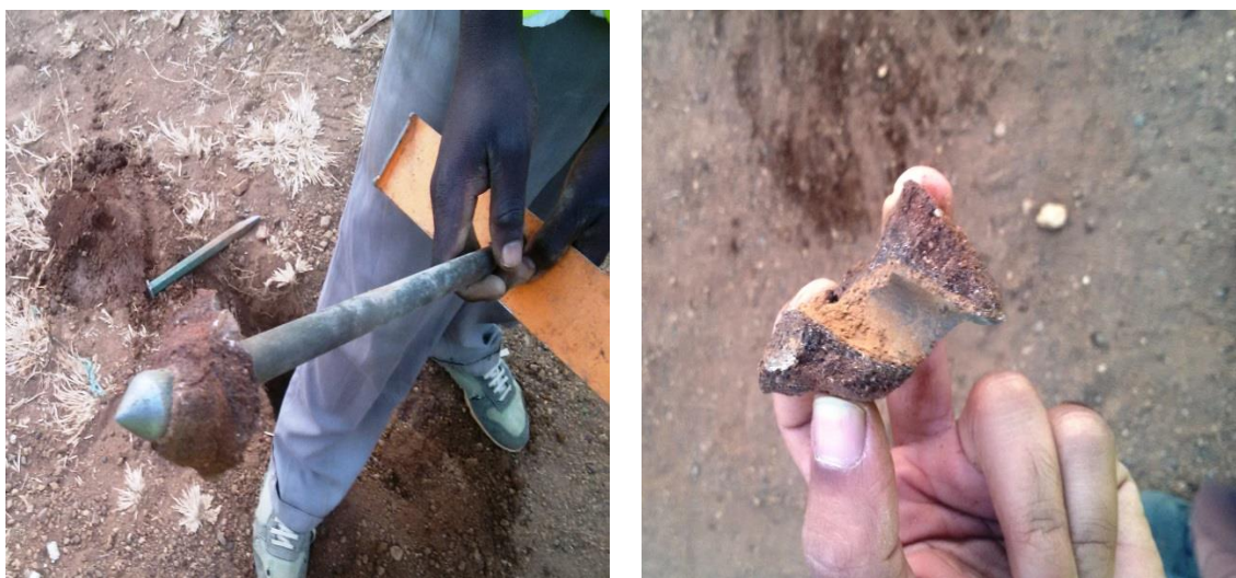
Figura 12 – Estado de cimentação do material laterítico em alguns locais [Fotos: Roughton Internacional Ltd.]
