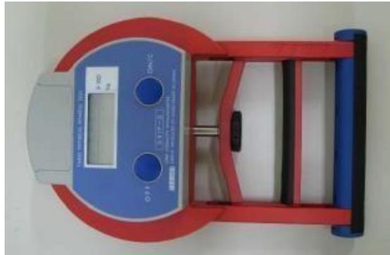
**Figura 11.** Dinamómetro de preensão manual digital Smedley Takei® TKK 5401 Grip-D.
